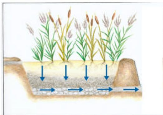
differenzia invece dai sistemi a flusso orizzontale in quanto non si utilizza una granulometria costante per tutto il letto, ma si dispongono alcuni strati di ghiaie di dimensioni variabili, partendo da uno strato di sabbia alla superficie per arrivare allo strato di pietrame posto sopra al sistema di drenaggio sul fondo
