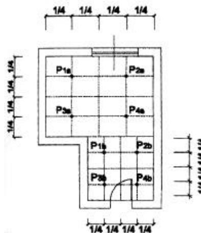
Per ogni subspazio va calcolata la media aritmetica dei valori di illuminamento rilevati nei quattro punti di misura. Il valore del FLD dello spazio in esame sarà la media pesata dei valori medi dei singoli subspazi.
