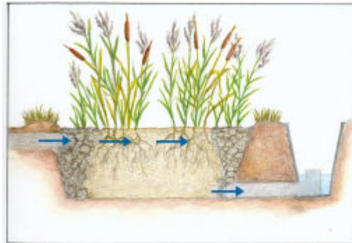
Durante il passaggio dei reflui attraverso la rizosfera delle macrofite, la materia organica viene decomposta dall'azione microbica, l'azoto viene denitrificato, se in presenza di sufficiente contenuto organico, il fosforo e i metalli pesanti vengono fissati per assorbimento sul materiale di riempimento;
