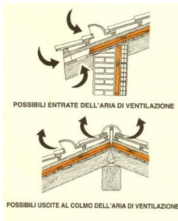
Le coperture devono essere correttamente costruite con materiali duraturi e che non abbiano necessità di manutenzioni frequenti e realizzate con materiali permeabili al vapore.
